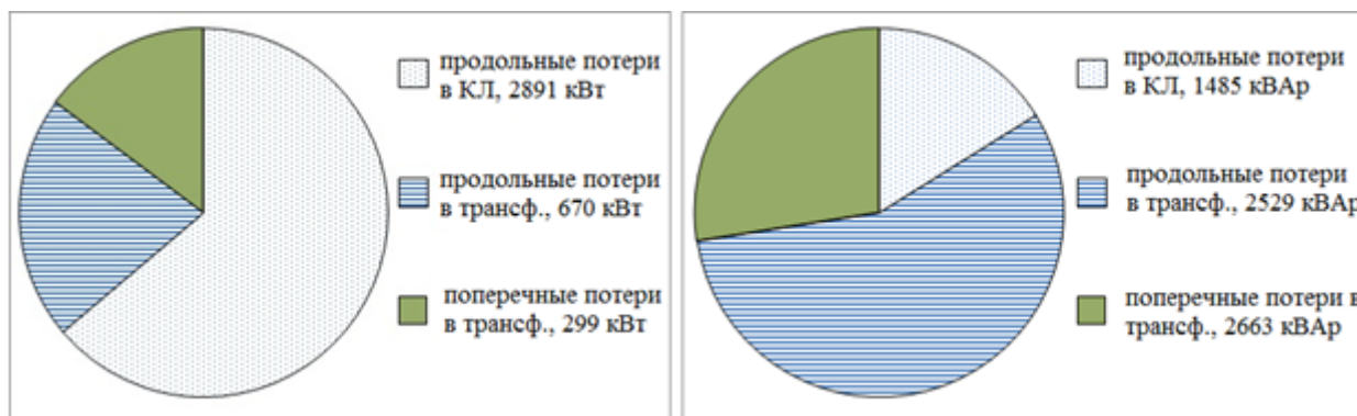
Рис. 4. Структура потерь активной и реактивной мощностей в исследуемой сети
