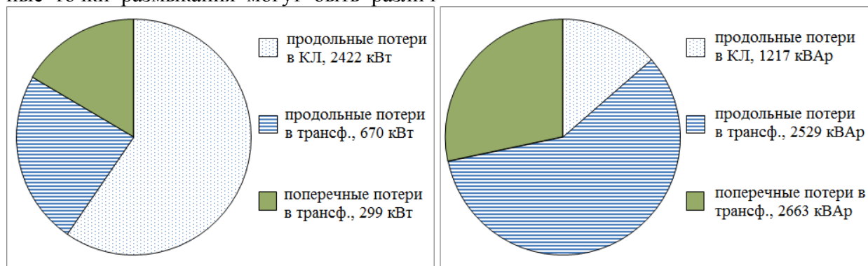
Рис. 5. Структура потерь активной и реактивной мощностей в распределительной сети после оптимизации
