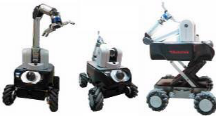
Рис. 9.7. Мобільний робот з багатоланковим маніпулятором та антропоморфним захоплюючим пристроєм
