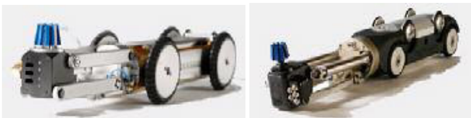
Рис. 15.17. Роботи для проведення фрезерувальних робіт у трубопроводах
