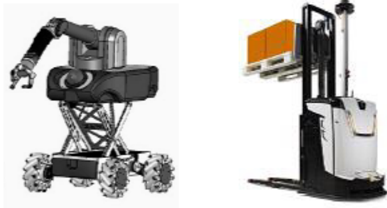
Рис. 2.5. Мобільні роботи з маніпулятором та вилочним захоплюючим пристроєм
