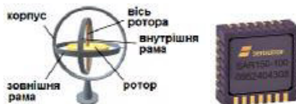
Рис. 10.14. Конструкція та зовнішній вигляд гіроскопічного датчику
