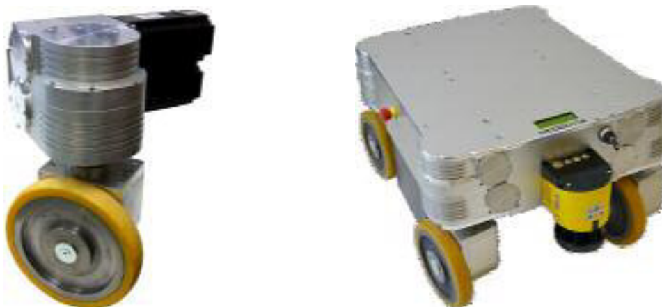
Рис. 8.10. Двовісний модуль повороту та переміщення Omni-Drive-Module Neobotix та мобільний робот МРО-700
