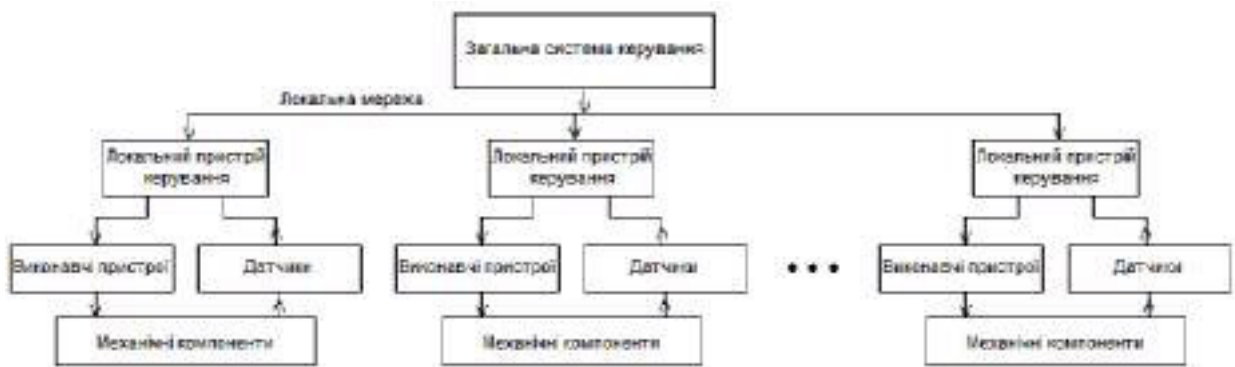
Рис. 5.12. Розподілена система керування крокуючим мобільним роботом
