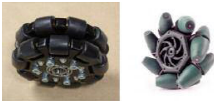
Рис. 3.2. Шведські колеса з роликами, що повернені на 90^\circ і 45^\circ
