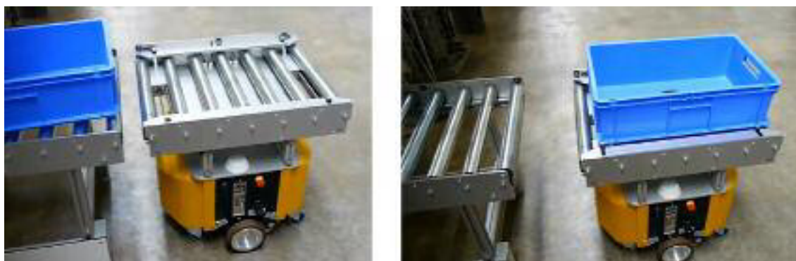
Рис. 14.10. Встановлення та знімання вантажу з конвеєрів.
