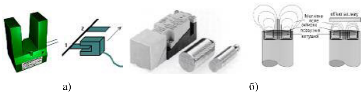
Рис. 10.3. Датчик з щілинним (а) та площинним (б) чутливим елементом
