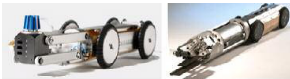
Рис. 9.15. Мобільні роботи для проведення фрезерування та нанесення захисного покриття в трубопроводах
