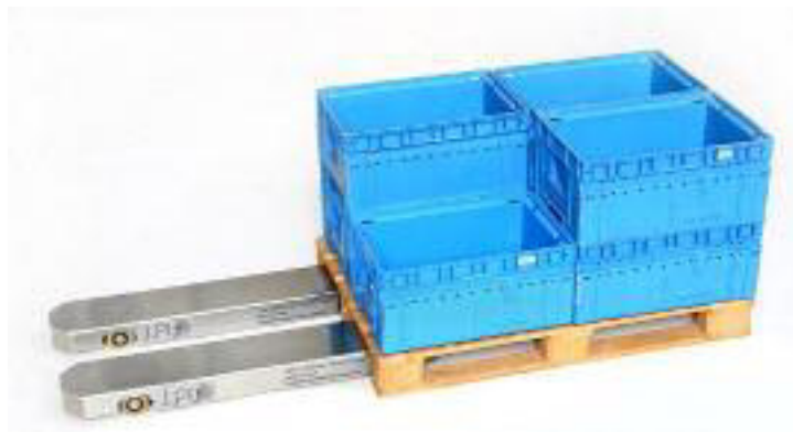
Рис.14.16. Переміщення палет за допомогою подвійних полозів
