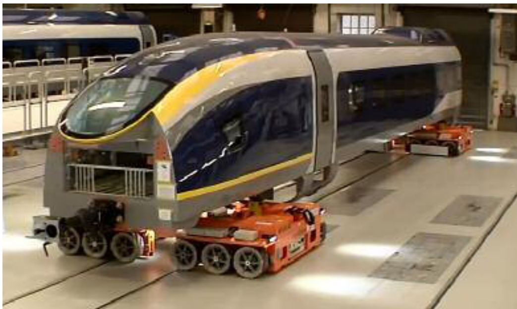
Рис. 14.13. Сумісне переміщення транспортних роботів для вантажів з великою довжиною.
