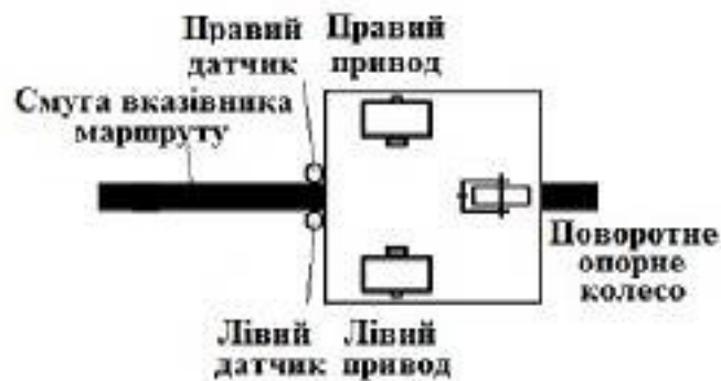
Рис. 11.2. Візок з маршрутослідкуванням за допомогою двох оптичних датчиків
