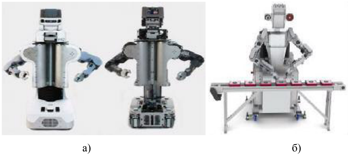
Рис. 15.14. Мобільні роботи з двома маніпуляторами, mobile PR2 dual-arm robot (а) та PISA WORKERBOT (б)
