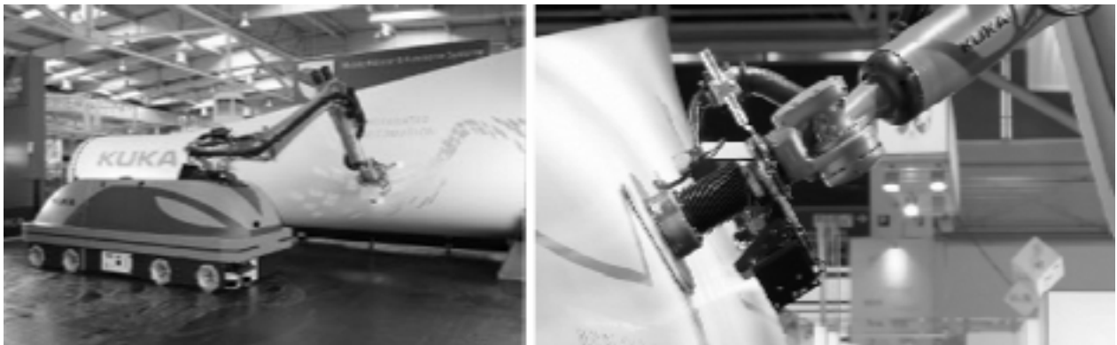
Рис. 9.1. Маніпуляційні мобільні роботи з різними типами захоплюючих пристроїв та обладнанням для виконання технологічних операцій, а - мобільні роботи з затискними захоплюючими пристроями, б - мобільні роботи з технологічним обладнанням
