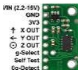
Рис. 10.13. Акселерометр з вимірюванням по 3 осям Pololu на MMA7341L
