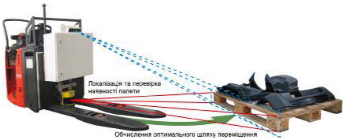
Рис. 6.12. Приклад використання лазерних датчиків для локалізації та перевірки наявності палети та обчислення оптимального шляху переміщення
