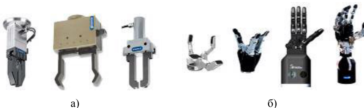
Рис. 9.2. Затискні (а) та антропоморфні (б) захоплюючі пристрої
