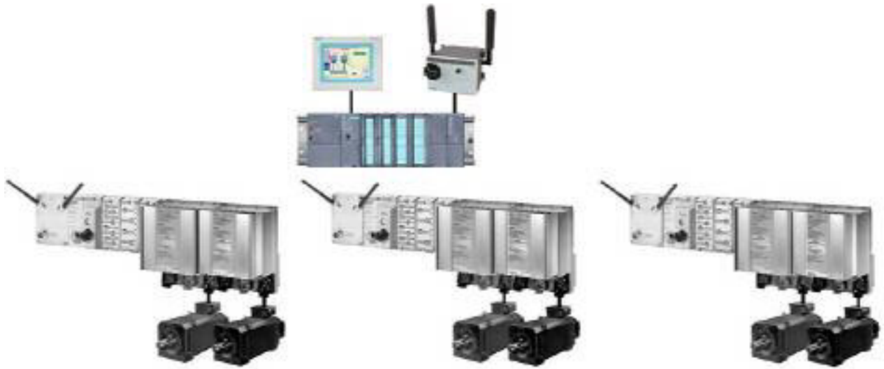
Рис. 13.1. Приклад розподіленої системи керування з використанням бездротового зв'язку
