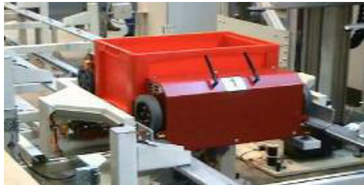
Рис. 2.10. Приклад використання бездротового інтерфейсу W - LAN для керування візками транспортної системи
