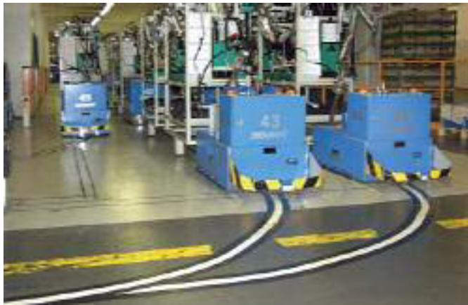
Рис. 8.25. Приклад використання транспортних роботів з бездротовим живленням
