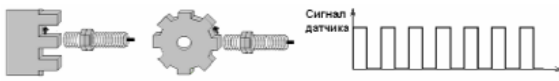
Рис. 10.4. Використання індуктивних датчиків для визначення лінійного та кругового переміщення
