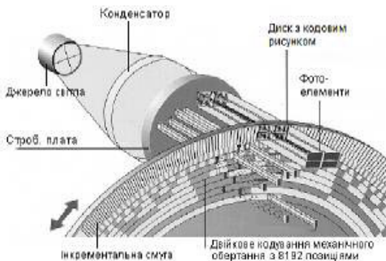
Рис. 10.10. Принцип роботи абсолютних датчиків
