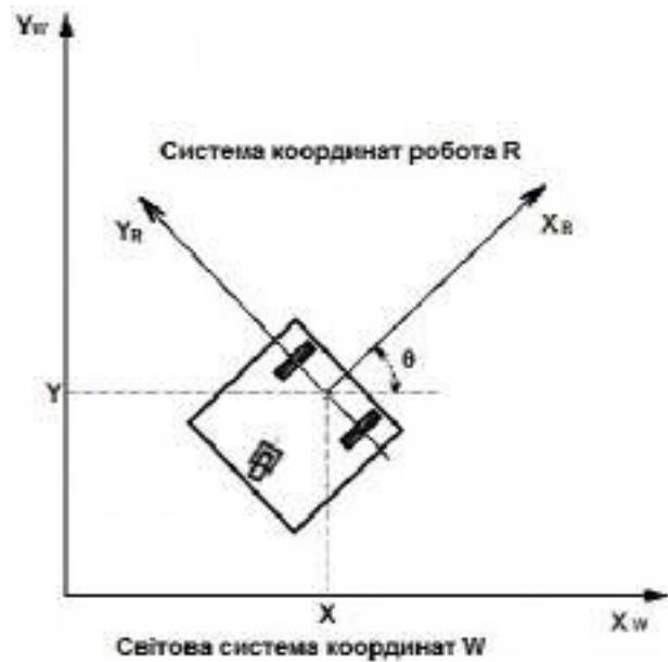
Рис. 3.12. Системи координат - світова система координат W (яка нерухома в просторі), і система координат робота R
