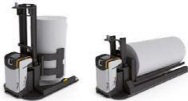
Рис. 14.20. Навантажувачі з захоплюючими пристроями для перенесення різних вантажів
