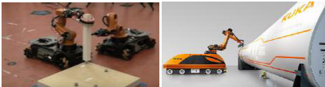
Рис.1.11. Експериментальний мобільний робот KUKA youBot та робот для виконання технологічних операцій KMR QUANTEC
