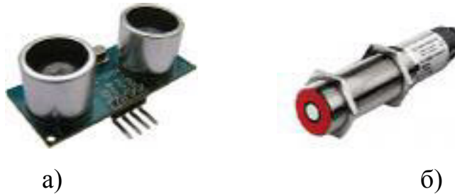
Рис.10.16. Ультразвукові датчики відстані: HC-SR04 (а) та VRTU 430 (б)
