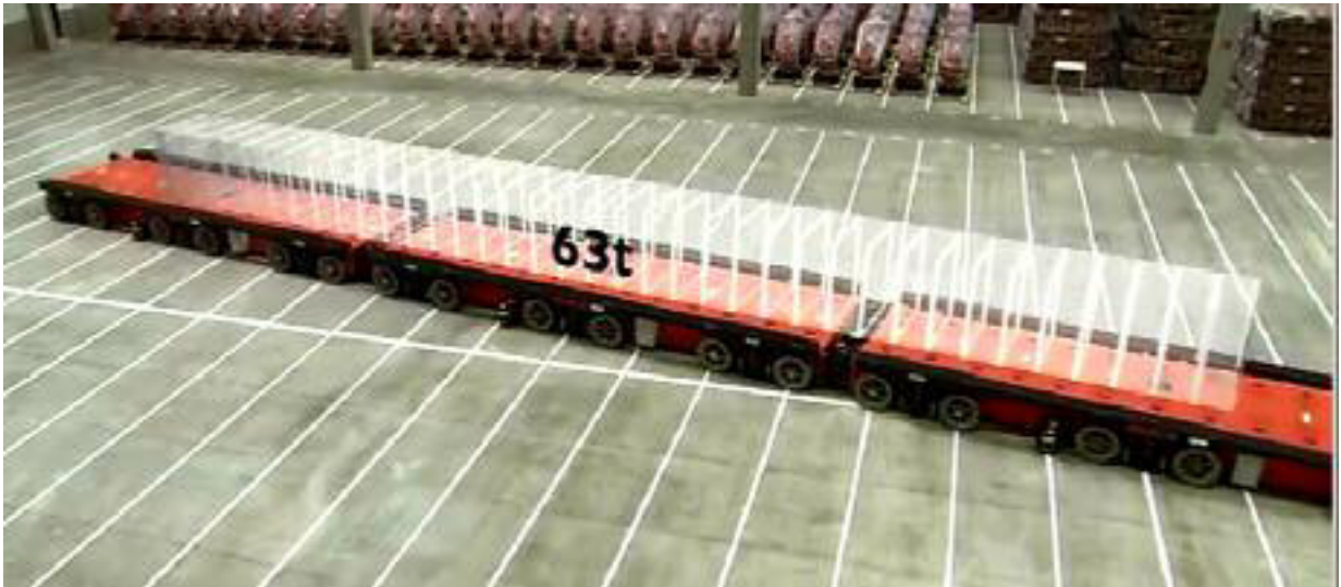
Рис. 14.12. З'єднання транспортних роботів для створювання єдиної платформи
