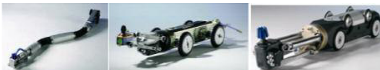
Рис. 1.12. Мобільні роботи фірми ProKasro для проведення фрезерування в трубопроводах
