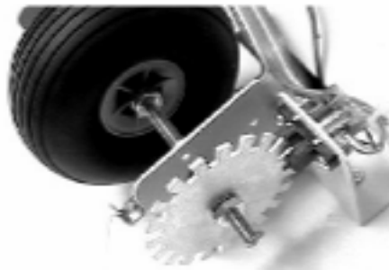
Рис. 10.6. Використання щілинного оптичного датчика для вимірювання кута повороту колеса
