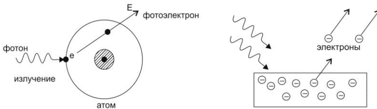
Рис. 4.2. Схематическое изображение процессов при фотоэффекте
