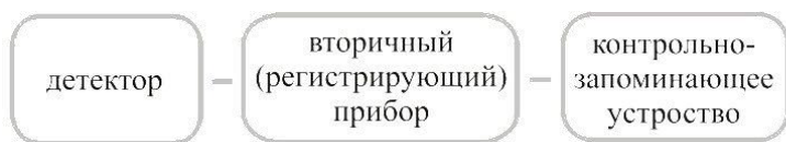
Рис.11.1 Общая структура типового радиометра
