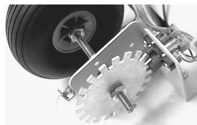
Рис. 5. Упрощенный принцип действия одометрического датчика
