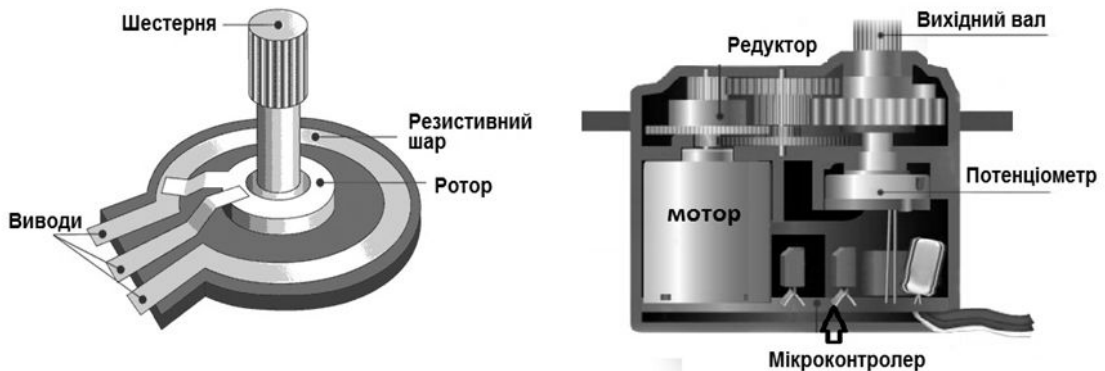
Рис. 6.2. Використання потенціометричного датчика (а) для визначення кута повороту сервопривода (б)
