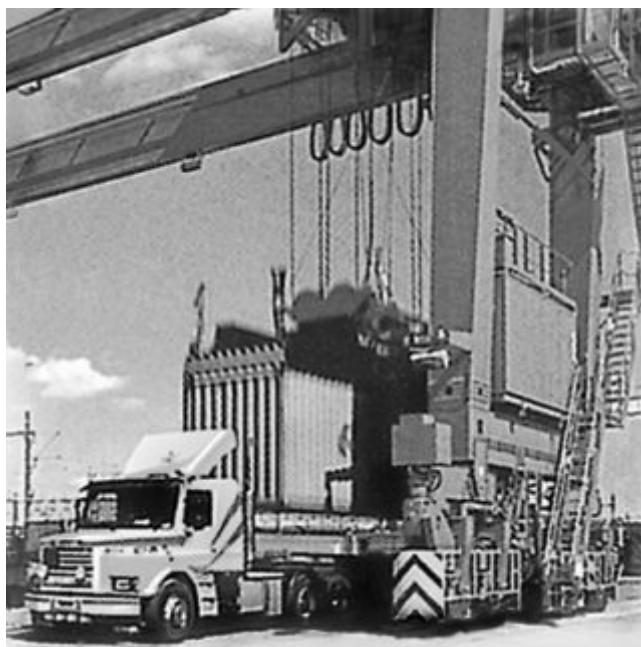
Рис. 13.3. Рейковий автоматичний кран-штабелер
