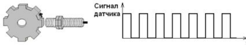
Рис. 4.1. Використання індуктивних датчиків для визначення кругового переміщення
