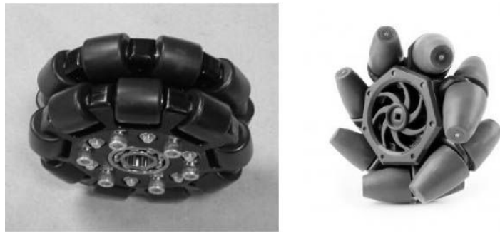
Рис. 1.2. Шведські колеса з роликками, що повернені на 90^\circ і 45^\circ
