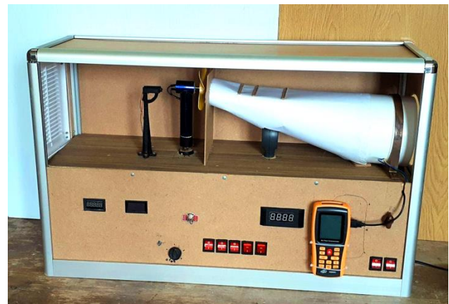
Рис. 1. Лабораторний стенд «Вітроенергетика» (зовнішній вигляд)
