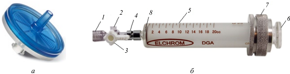
Рис. 1. Мундштук ( a ) і шприц ( б ) для відбору проби видихуваного повітря пацієнта: 1 – з'єднувальна муфта; 2 – патрубок; 3 – з'йомний триходовий кран; 4 – металева кінцівка; 5 – корпус шприца; 6 – поршень; 7 – вузол герметизації з еластичною силіконовою прокладкою; 8 – проба аналізованого газу
