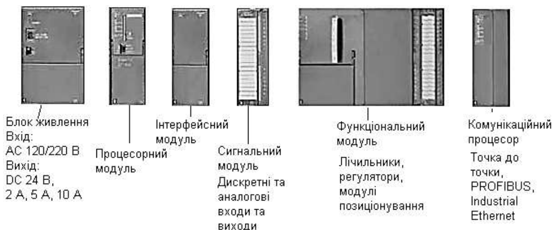
Рис. 5.5. Модулі, що входять у склад контролерів SIMATIC S7-300
