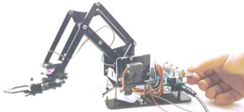
Рис.4.18 Маніпулятор з чотирма сервоприводами
