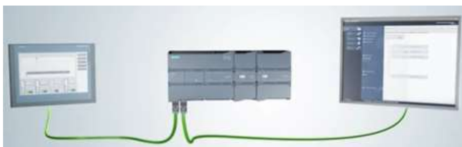
Рис. 6.10. Засоби відображення та введення інформації у складі ПЛК SIMATIC S7-1200
