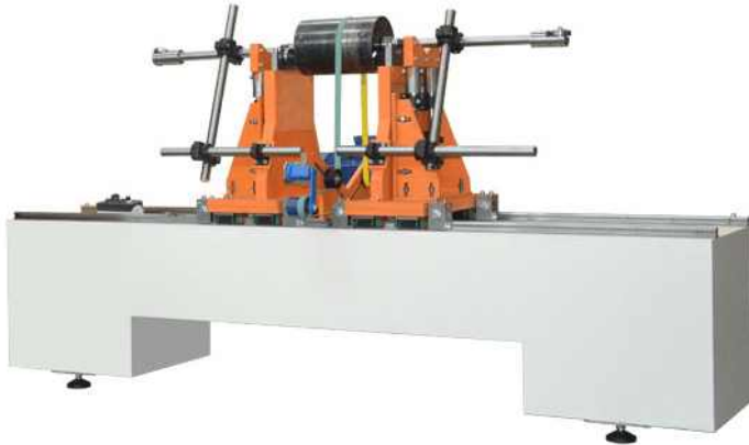
Рис.13.17. Балансировочный станок дорезонансного типа ТБ-500 позволяет балансировать роторы весом до 500 кг и максимальным расстоянием между шейками до 2000 мм
