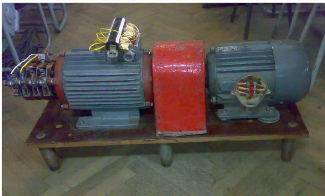
Рисунок Д.15 – Макетный генератор для исследования разностных ЭДС с приводным двигателем в сборе
