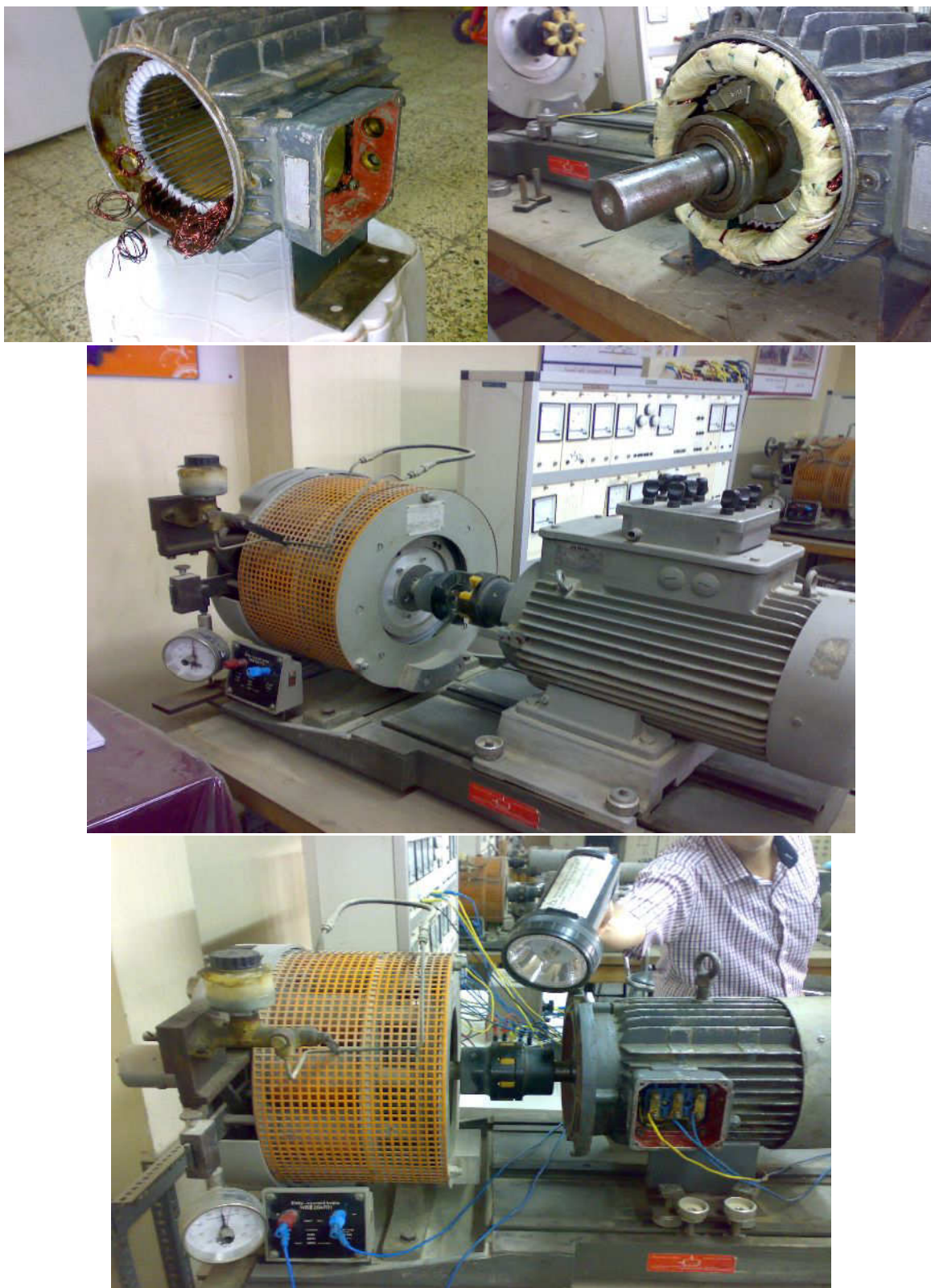
Рисунок 5.5 – Этапы изготовления и испытания экспериментального образца в Багдадском университете
