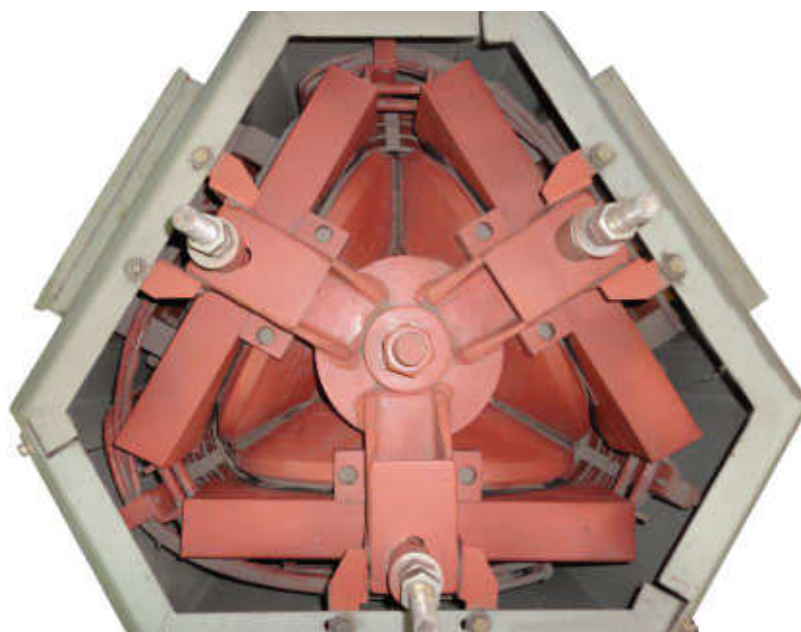
Рисунок 2.3 – Загальний вигляд (а) та вигляд зверху зі знятою кришкою (б) трифазного трансформатора ТСЗМ-40-74.ОМ5 морського виконання потужністю 40 кВ·А
