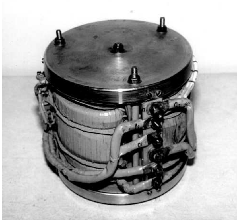
Рисунок 2.5 – Трифазний трансформатор з просторовим стиковим магнітопроводом потужністю 6,3 кВ·А
