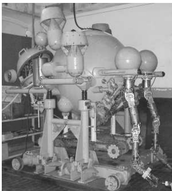
Рисунок 1.4 – Самохідний (в зануреному і донному положеннях) опускний підводний апарат «МТК – 200»
