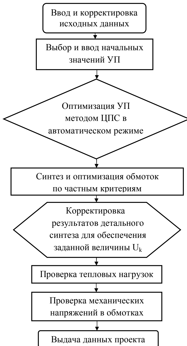
Рисунок 3.1 – Блок-схема оптимального синтеза трансформатора методом ЦПС
