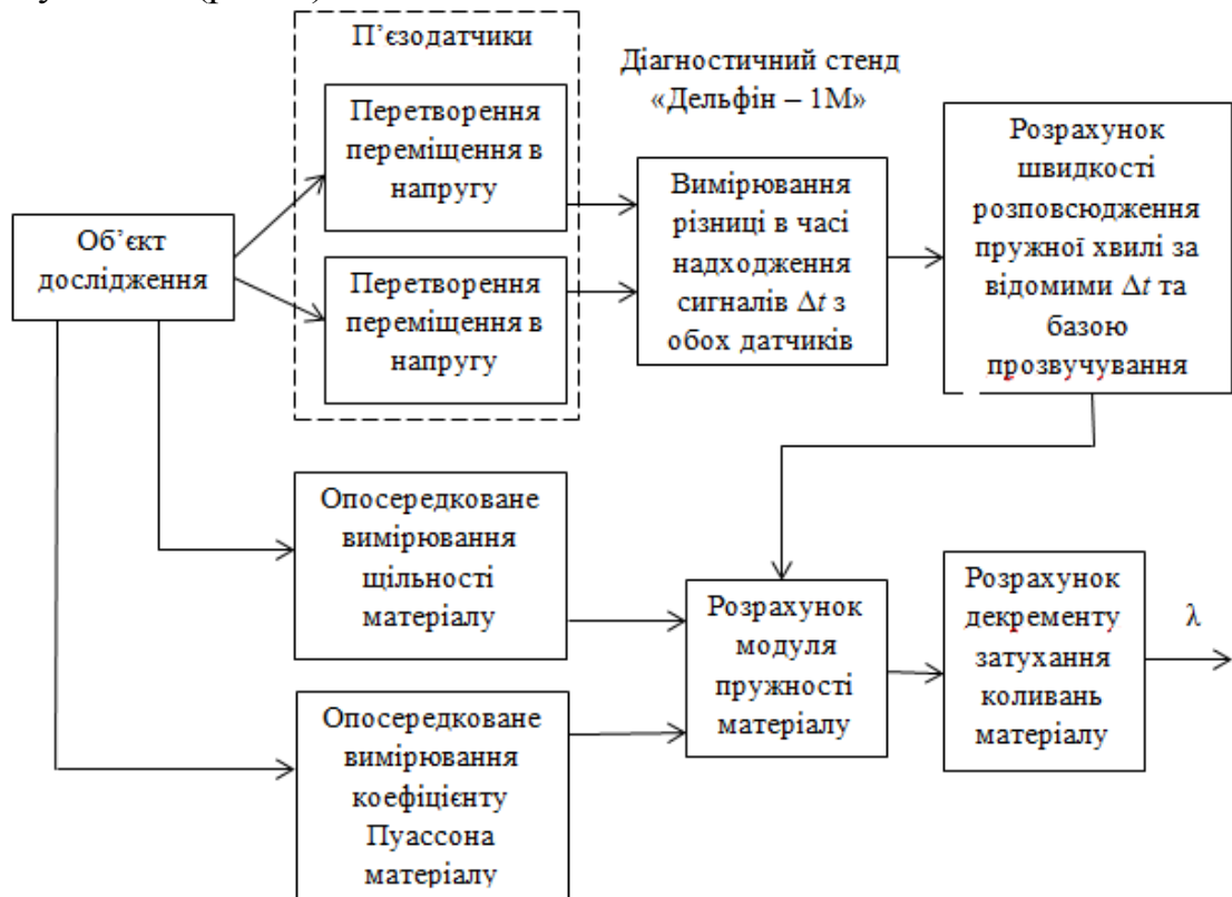
Рисунок 7 – Блок-схема перетворень вимірюваної величини в запропонованому методі вимірювання дисипативних властивостей неметалевих гетерогенних матеріалів
