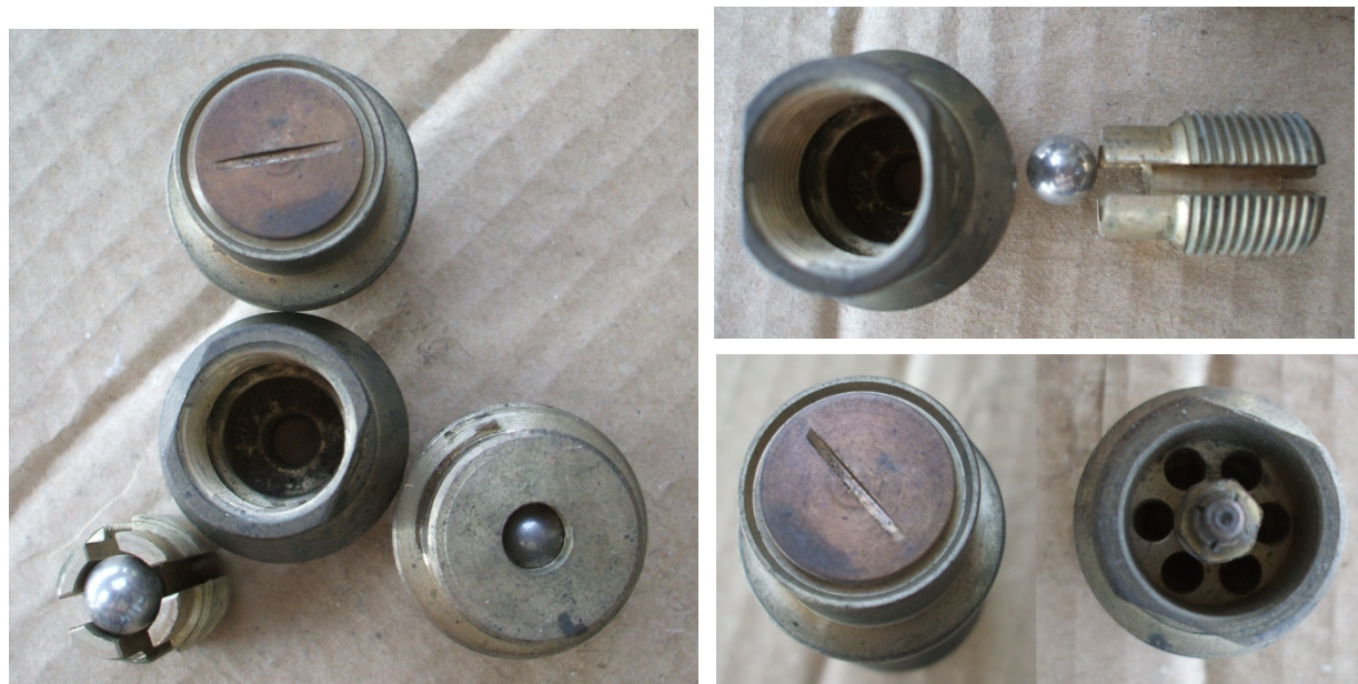
Рис. 4.6. Внешний вид всасывающего клапана (справа сверху) и разобранного напорного, где хорошо виден шарик-затвор из ферромагнитной стали(справа внизу)
