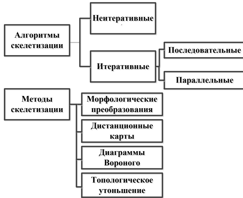
Рисунок 1.10 – Классификация алгоритмов скелетизации на 3 пикселя),
