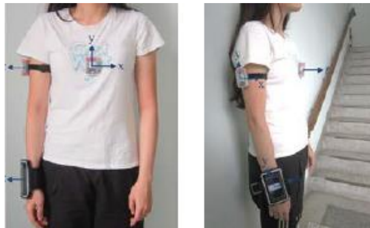
Рисунок 1.3 – Пример системы с акселерометрическими и гироскопическими датчиками, закрепляемыми на теле пациента [25]
