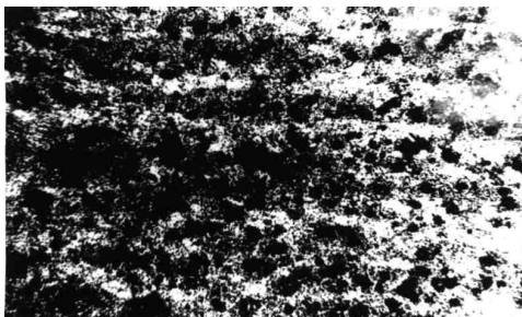
Рис. 3. Темный прижог отпуска при увеличении \times 150 совместно с прижогом закалки
