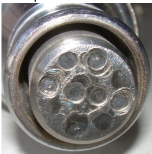
Рис. 2. Торець робочої накладки ультразвукового молотка
