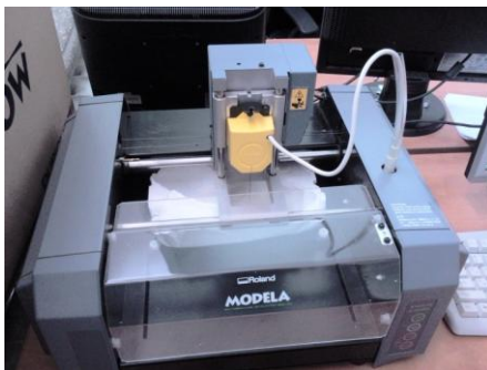
Рис. 1. Процесс сканирования на принтере Roland MODELA MDX-20
