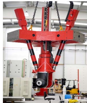
Рис.3. Фрезерний верстат T805 (Tricept) фірми MIKROMAT (Німеччина)
