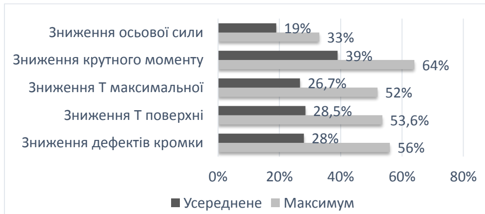
Фігура 12. Ефективність двошарового алмазного кільцевого свердла з зернистістю 200/160 + 63/50 в порівнянні зі звичайним кільцевим свердлом з зернистістю 63/50.
