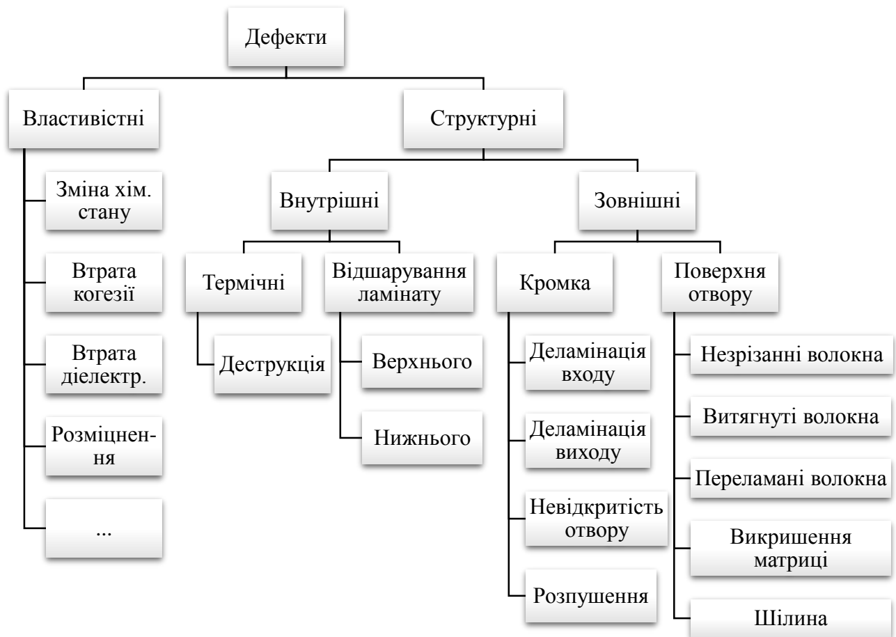
Фігура 13. Класифікація дефектів при обробці отворів в ПКМ.
