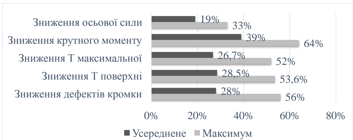
Рисунок 5.3.1 – Переваги різнозернистої обробки отворів.
