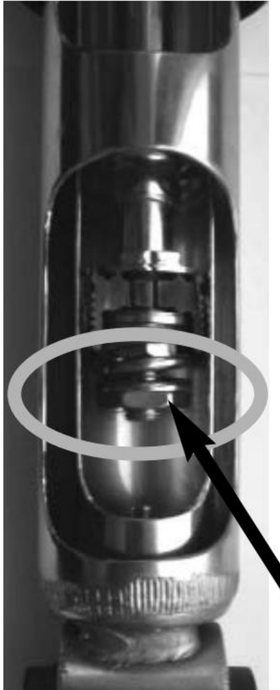
Рисунок Д.7 – Погано затягнута гайка в амортизаторі
