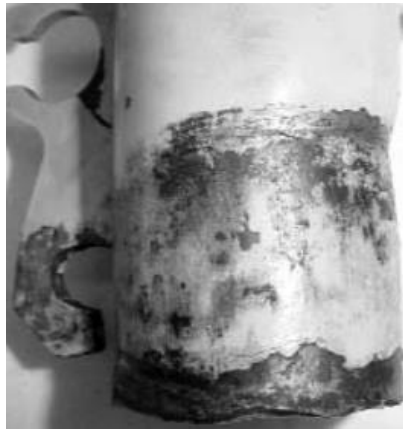
Рисунок Д.5 – Вм'ятина або ушкодження корпусу амортизатора
