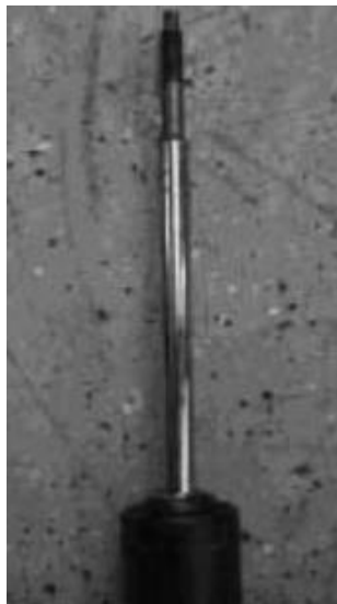
Рисунок Д.4 – Вигин штока амортизатора
