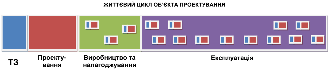
Рисунок 2.2 – Життєвий цикл об'єкта проектування із відмовами I рівня (відмови виробництва та експлуатації)
