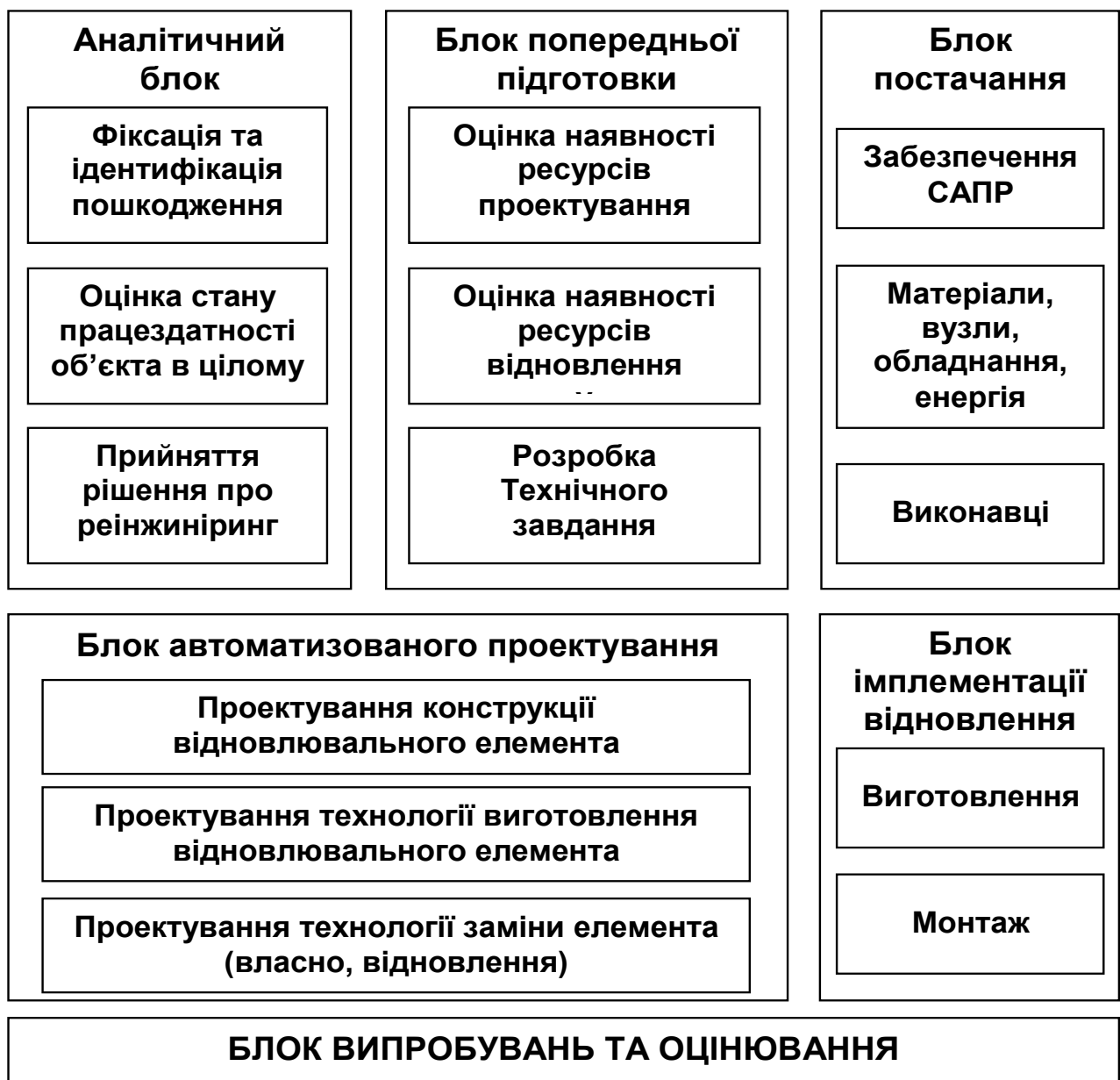
Рисунок 2.18 – Загальна схема САПР та оцінки ефективності відновлення (реінжинірингу)
