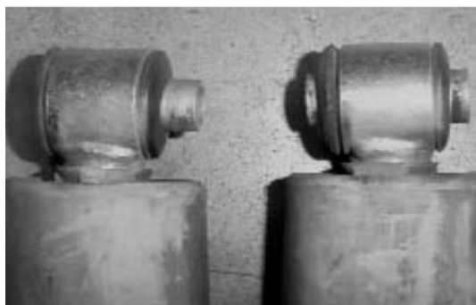
Рисунок Д.6 – Руйнування / видавлювання резинометалічної втулки з вушка кріплення амортизатора
