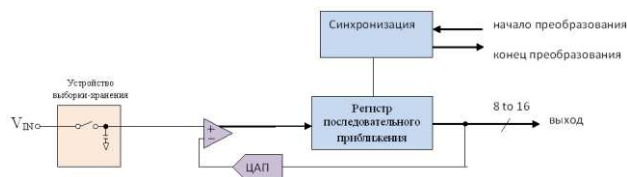
Рис. 2 – АЦП последовательного приближения
