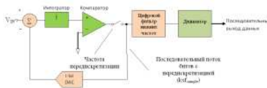
Рис. 3 – АЦП сигма-дельта преобразования
