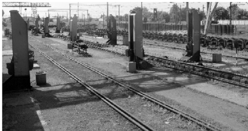
Рис. 2. Место смены колесных тележек на станции Чоп.
