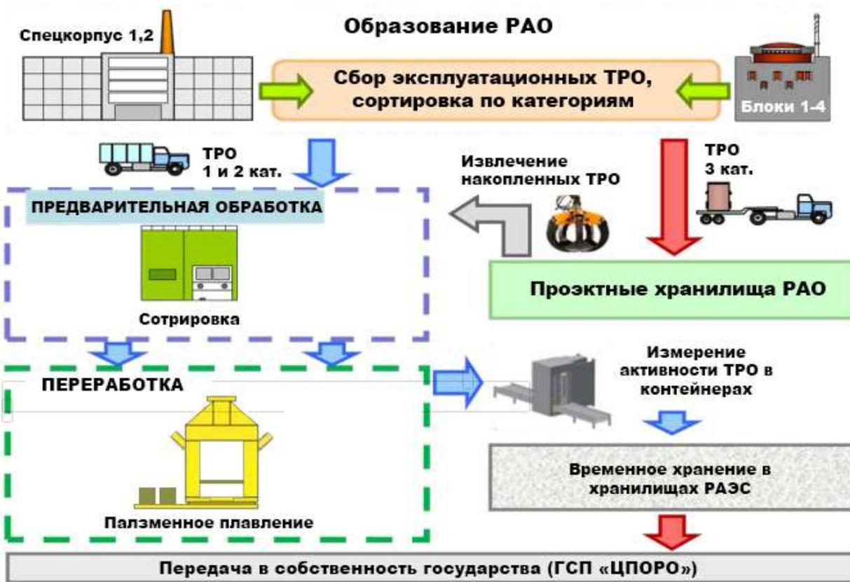
Рисунок 10. Схема предлагаемого комплекса переработки ТРО РАОС, включающего плазменную переработку
