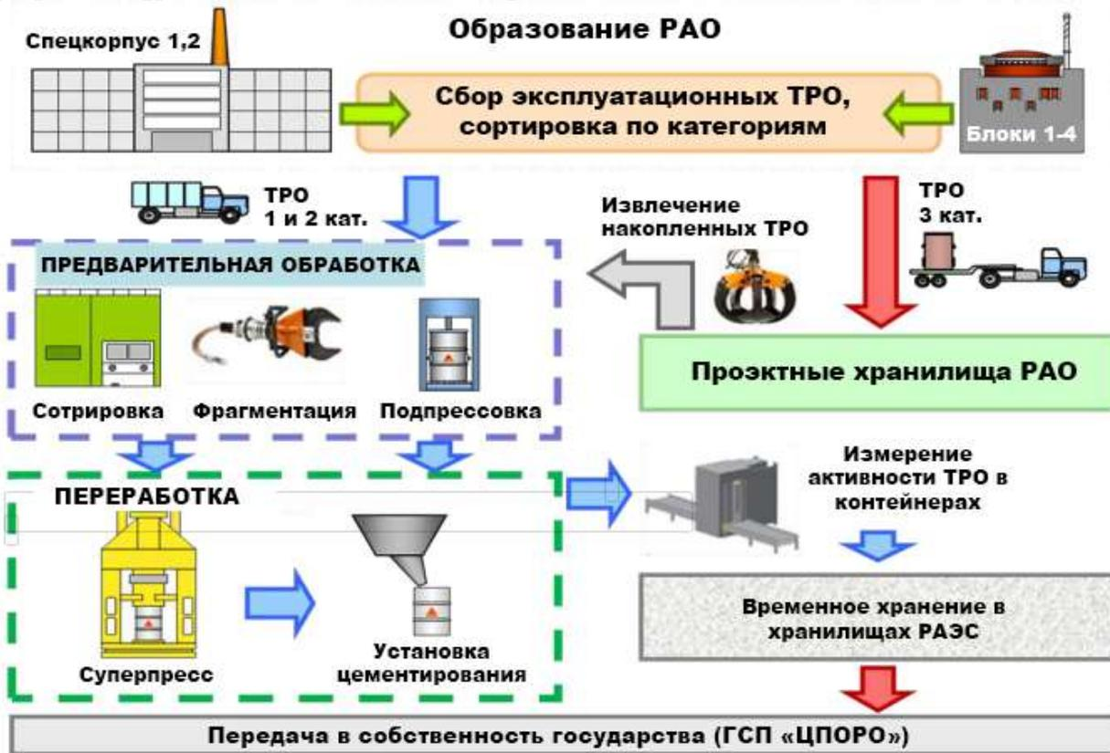
Рисунок 8. Схема создаваемого на РАЭС комплекса по переработке ТРО
