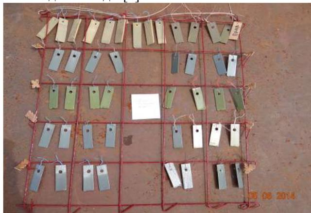
Фото 1. Общий вид установки для экспонирования субстратов в воде на Каневском водохранилище, дата установки стенда 5.06.2014
