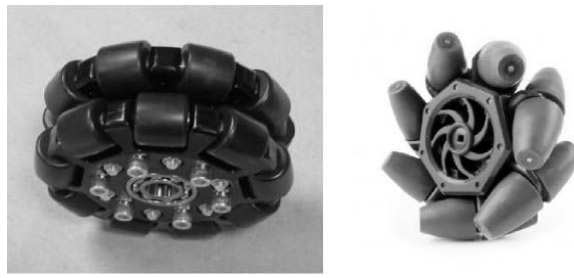
Рис. 22.2. Шведські колеса з роликами, що повернені на 90^\circ і 45^\circ
