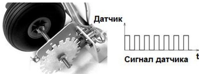
Рис. 11.11. Використання щілинного оптичного датчика для вимірювання кута повороту колеса
