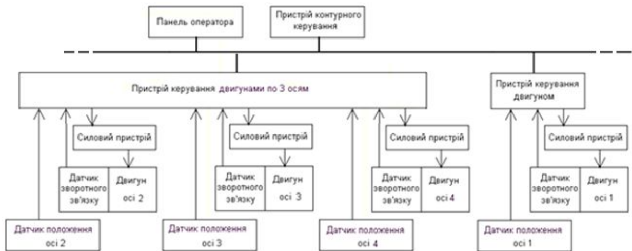
Рис. 9.6. Система контурного керування
