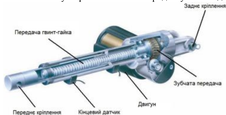
Рис 24.12. Принцип дії лінійного актуатора на основі електродвигунів
