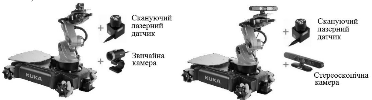
Рис. 21.3. Мобільні роботи youBot з додатковими датчиками
