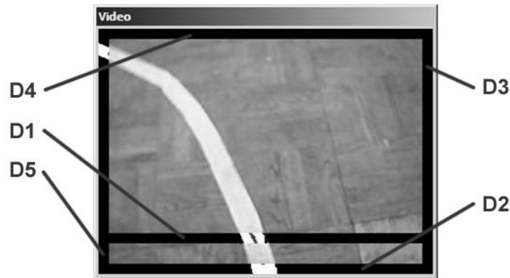
Рис. 12.14. Використання відеокамери для переміщення по траєкторії
