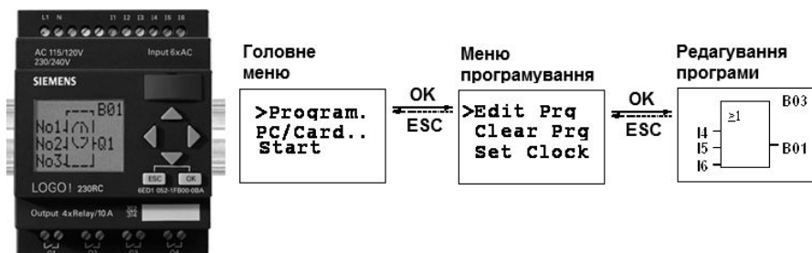
Рис. 19.2. Програмування логічного модуля LOGO! за допомогою вмонтованого дисплея
