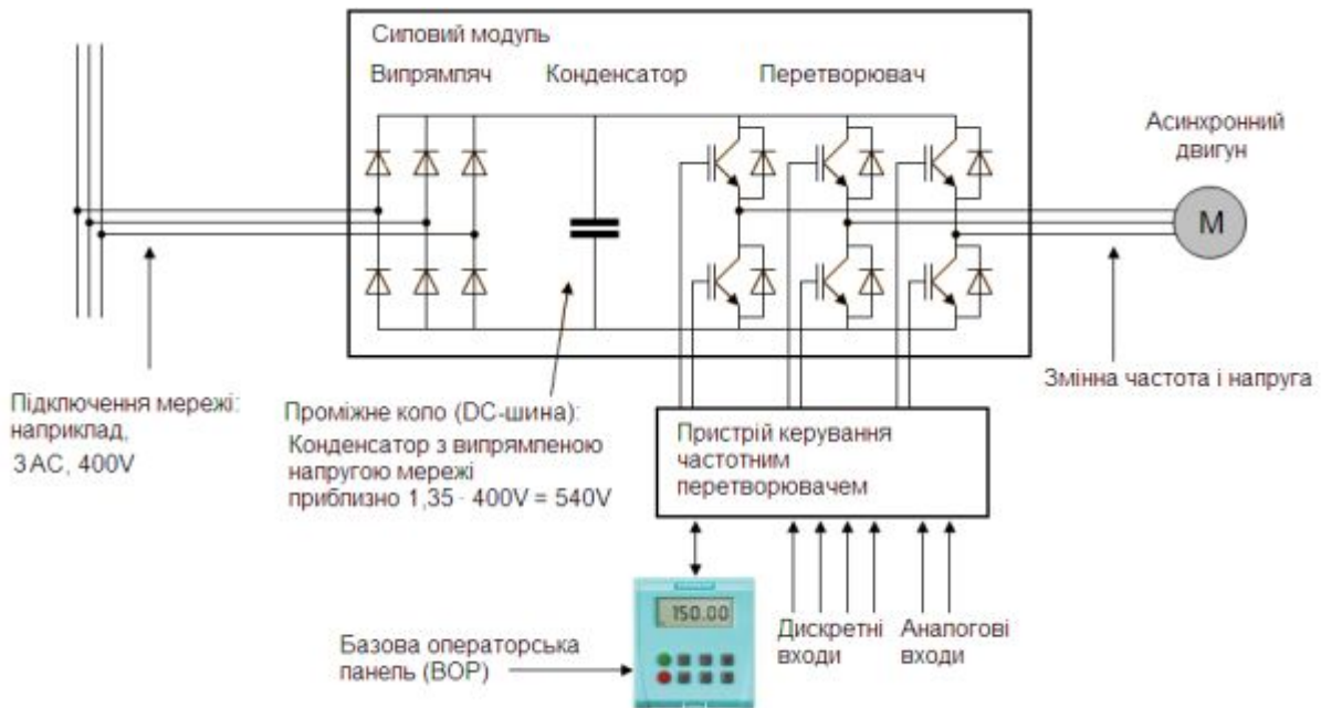
Рис. 13.10. Спрощена схема частотного перетворювача
