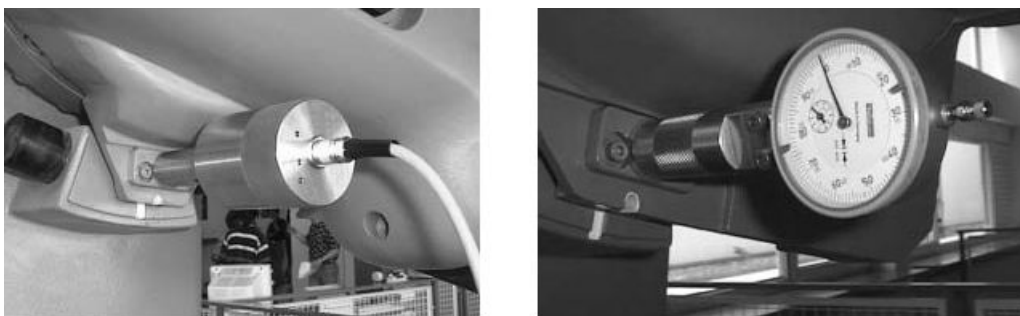
Рис. 16.7. Юстування за допомогою контактної вимірювальної головки або стрілочного індикатора
