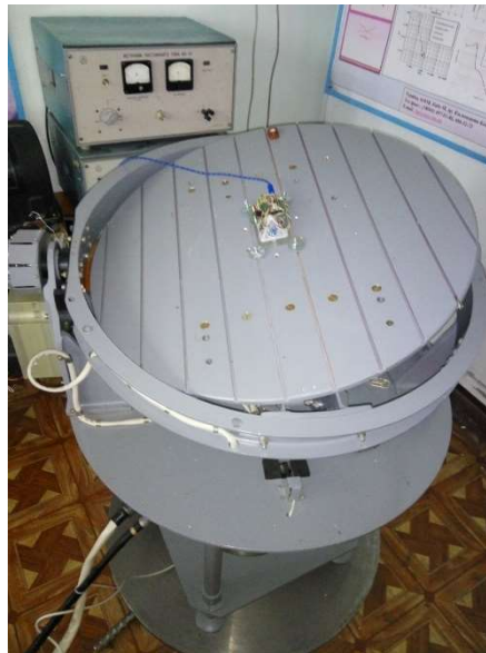
Рис. 2. Триступеневий динамічний стенд
