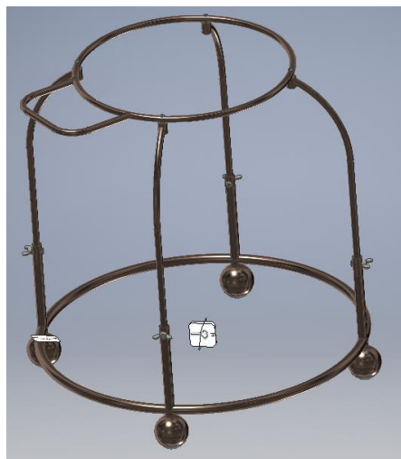
Рис. 6. Удосконалена модель опори для ходьби дитини хворою на ДЦП порівняно з аналогічними моделями представленими на ринку
