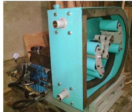
Рис. 1. Універсальний безпоршневий шланговий бетононасос нового конструктивного рішення з гідравлічним приводом
