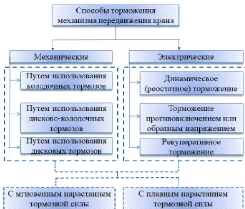
Рис. 1. Классификация способов торможения механизма передвижения мостового крана
